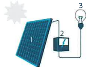
1. Zonnepaneel | 2. Omvormer | 3. Elektrische toestellen
